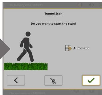
Gehen Sie zum Startpunkt und starten Sie die Messung mit ✓ oder per Trigger am Gestänge. Laufen Sie los, sobald Sie den Trigger drücken.
