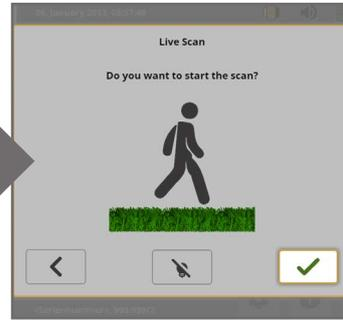
Gehen Sie zum Startpunkt und starten Sie die Messung mit ✓ oder indem Sie den Trigger am Gestänge drücken.
