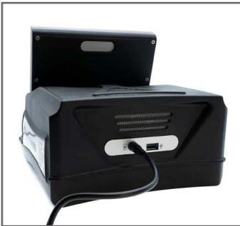
Empfohlen: Ladegerät an Kontrolleinheit anstecken, um Ladestand zu prüfen bzw. Akkus zu laden.
