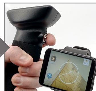
3 Detektor am Taster einschalten: LED-Ring wird grün. OKM Rover UC App auf der Smartwatch starten.
