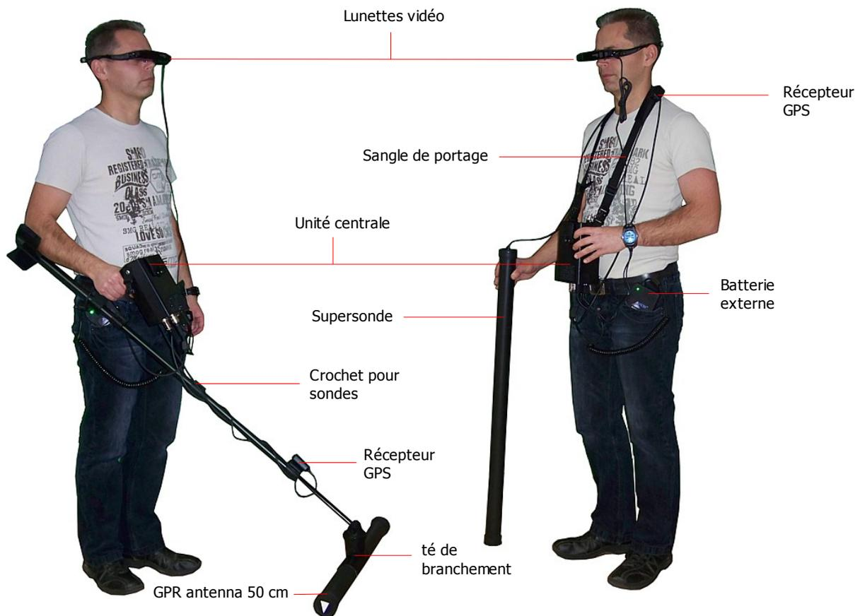
Figure 6.1: Unité central avec lunettes vidéo, batterie externe et sonde
