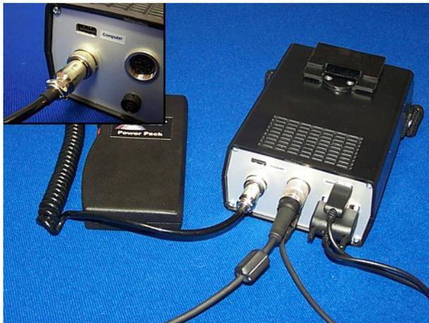
Figure 5.4: Connexion de la batterie externe (Power Pack)
