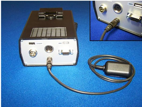
Figure 5.1: Connexion du récepteur GPS
