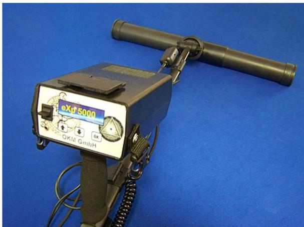
Figure 5.5: Accrocher l'unité centrale au crochet des sondes
