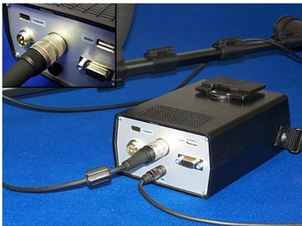
Figure 5.2: Connexion de la sonde
