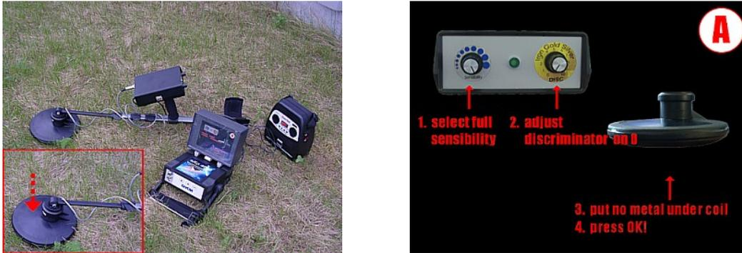
Figure 9.3: Calibrage du système DDV, démarche 1
