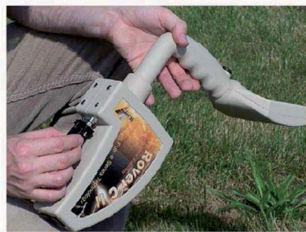
Figura 6.1: Conexión chip de control
