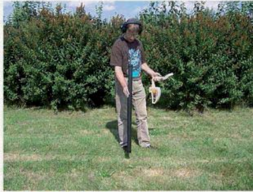
Figura 7.9: Posición de la Supersensor durante una medición de terreno.
