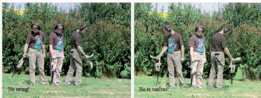
Figura 7.3: Dar un giro o de inflexión de la sonda de falsifies la medición
