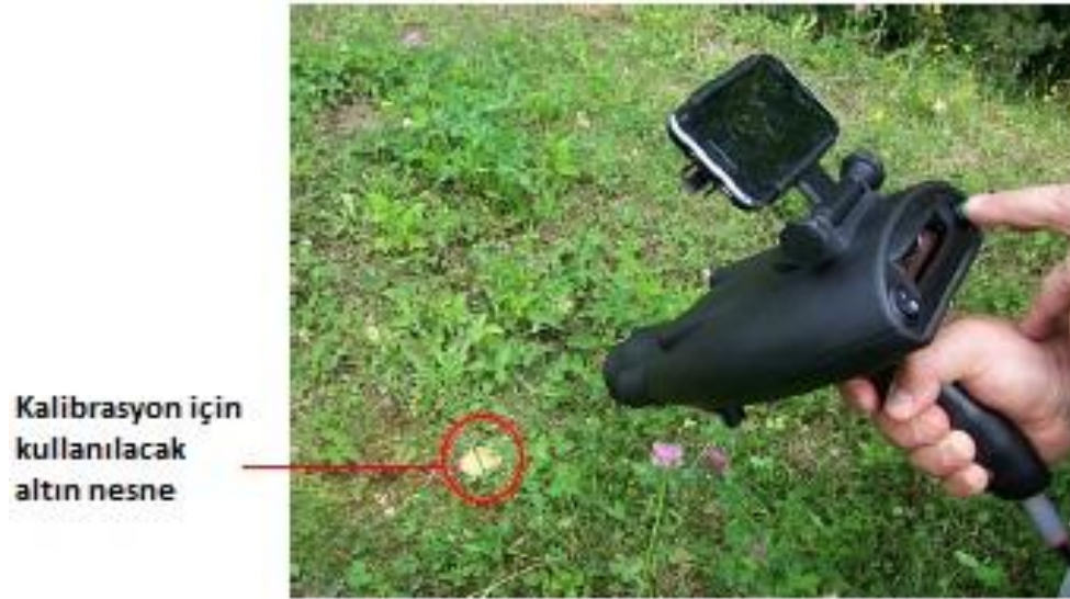
Şekil 6.9: Cihazın İyonik Modda Bir Altın Nesne İle Kalibrasyonu
