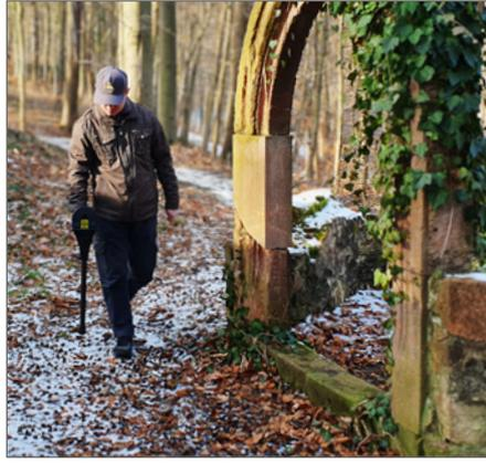
Mit der Betriebsart Magnetometer wird das Messfeld für tiefreichende 3D-Bodenmessungen vorbereitet. Auf diese Weise lassen sich Zielobjekte noch tiefer im Untergrund lokalisieren und mit der bewährten 3D-Darstellung in Größe und Position genauer bestimmen.
