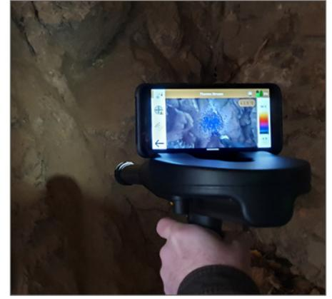
Die Thermografie-Betriebsarten ermöglichen es, versteckte Tunnel und Grabkammern zu detektieren, indem Wand- und Bodenflächen auf Temperaturunterschiede untersucht werden. Die Messergebnisse werden visuell am Smartphone-Bildschirm angezeigt.
